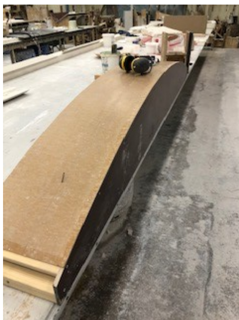
Till vänster: Den träbåge som fungerat som underlag för att motsvara tornets form. Till höger: Den släde för listdragning som använts vid nyttillverkning av profilerade stucklistor. Foto: Daniel Hillman.
